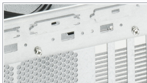
Rückseitig ausbrechbare Schnittstellenfelder
