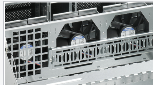
Lüfterbrücke im Chassis-Innenraum mit drei 120er Lüftern und Kartenhalter für lange Karten
