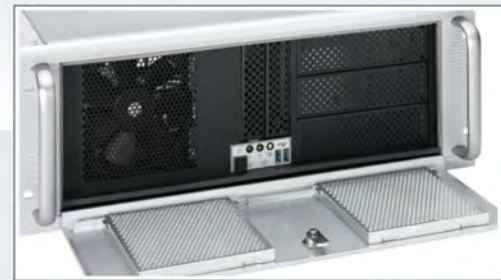
Verschließbare Fronttür (mit Bedienelementen)
